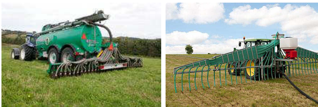
Figur 4.4. Illustrasjonsfoto av to miljøvennlige metoder for gjødselspredning. Ved bruk av slange (t.h.) slipper en den tunge gjødselsvogna på jordene. Bruk av tilførselsslange (t.h.) gir derfor ekstra støtte.
